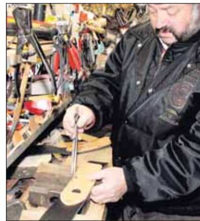
Enus Meichtry misst die Löcher für die Verzierungen mit dem Zirkel ein, bevor er sie ausstanzt.
